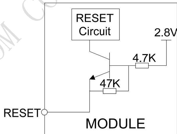
**Figure 14: Reset circuit**
