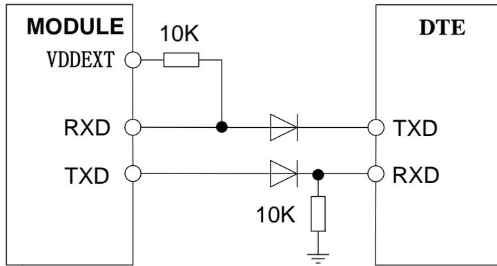
**Figure 21 : Diode isolation circuit**
