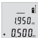
Tekan tombol **(6)** untuk menambahkan nilai pengukuran atau tekan tombol **(3)** untuk mengurangi nilai pengukuran. Pada display, akan muncul "+" atau "-" di bagian bawah. Lakukan pengukuran selanjutnya. Nilai pengukuran saat ini akan ditampilkan pada display bagian bawah, nilai pengukuran sebelumnya ditampilkan di atasnya.
