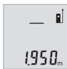
Untuk mengukur, tekan singkat tombol pengukuran (2). Nilai pengukuran ditampilkan pada display bagian bawah.
