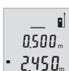
如需相加测量值，按压按键(6)，如需相减测量值，按压按键(3)。结果显示在显示屏下端的“=”之后，当前测量值则显示在其上方。
