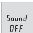
Tekan tombol pengukuran **(2)** beberapa saat hingga **"Sound OFF"** muncul pada display **(1)**. Setelah itu, alat pengukur akan hidup dengan pengaturan yang dipilih.
