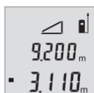
Setelah pengukuran kedua selesai, ketinggian secara otomatis dihitung dan ditampilkan. Hasil akhir pengukuran terletak pada display bagian bawah, nilai pengukuran saat ini terletak di atasnya.
