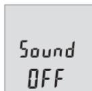
請長按測量按鈕 (2) 直到顯示器出現 (1) 「關閉音效」。放開按鈕後，測量工具即以此新設定啟動。
