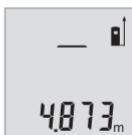
测量时短促按压测量按键(2)。测量结果会出现在显示屏下部。
