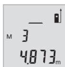
测量值编号显示在“M”后面，相应的测量值则显示在其下方。
