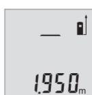
测量时短促按压测量按键(2)。测量结果会出现在显示屏下部。
