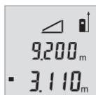
두 번째 측정을 하고나면 높이가 자동으로 계산되어 나타납니다. 최종 결과가 디스플레이 하단에, 현재 측정값이 그 위에 표시됩니다.
