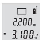
完成第二次測量後，將自動計算出面積並於畫面中顯示該值。最後的計算結果位於顯示器下方，而實際測量值則位於其上方。
