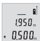
측정값을 더하려면 버튼 (6)을 누르거나, 측정값을 빼려면 버튼 (3)을 누르십시오. 디스플레이 하단에 "+" 또는 "-"가 표시됩니다. 다시 측정을 진행하십시오. 현재 측정값은 디스플레이 하단에, 이전 측정값은 그 위에 표시됩니다.
