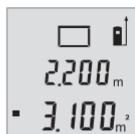
Setelah pengukuran kedua selesai, luas permukaan secara otomatis dihitung dan ditampilkan. Hasil akhir pengukuran terletak pada display bagian bawah, nilai pengukuran saat ini terletak di atasnya.
