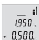
如需相加测量值，按压按键(6)，如需相减测量值，按压按键(3)。显示屏下端出现“+”或“-”。请进行另一项测量。当前测量值显示在显示屏下端，之前的测量值则显示在其上方。
