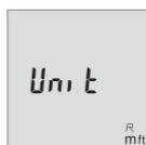
請長按電源開關 (5)。若要顯示所需的計量單位，請放開電源開關 (5)。放開按鈕後，測量工具即以此新設定啟動。
